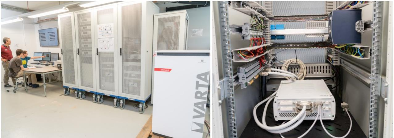
Abbildung 1 : Links: Die Hardware der Testanlage ist in mehreren Racks untergebracht (von L. n. R.: Energiezähler und EMS, PV-Emulation, Lastemulator, Netzemulator, Wechselrichter und Batteriespeicher). Rechts: Die MicroLabBox von dSpace ist das Herzstück der Anlage für den automatisierten Ablauf von Testszenarien.
